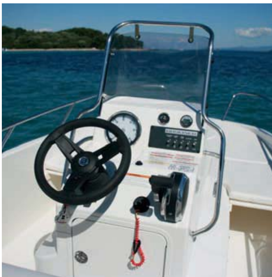
La consola central facilita el paso por los laterales.
