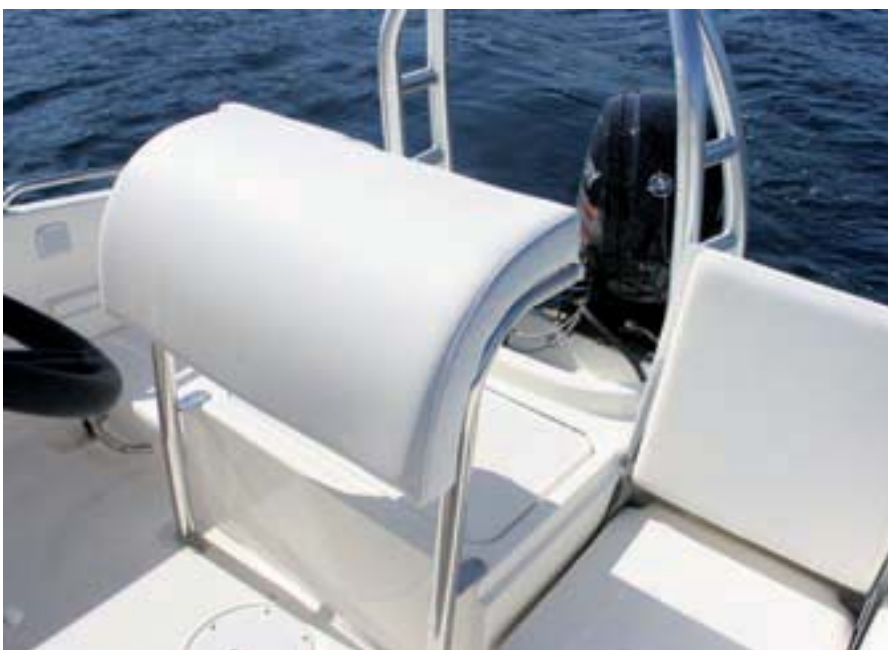
En la CC5 el asiento del piloto se desliza totalmente hacia popa.
