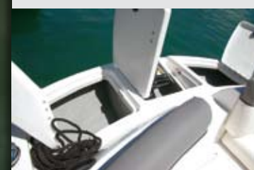
La plataforma de baño de proa integra tres cofres, el central encargado de ocultar la escalera de baño telescópica.
