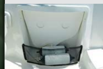
Junto a la mesa elevable, la instalación de una red textil ha permitido incorporar un práctico compartimento de estiba.
