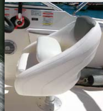
El sillón de pilotaje es ergonómico, regulable y permite conducir tanto sentado como de pie.
