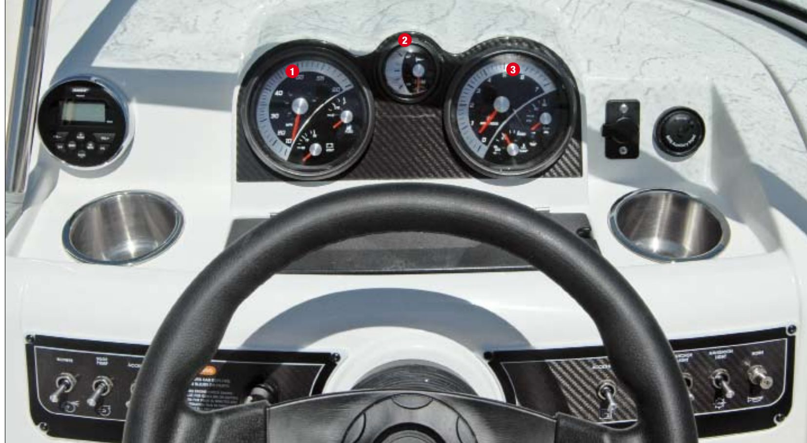
1. Velocímetro / Combustible / Voltímetro | 2. Trim | 3. Cuentarrevoluciones / Temperatura y presión aceite
