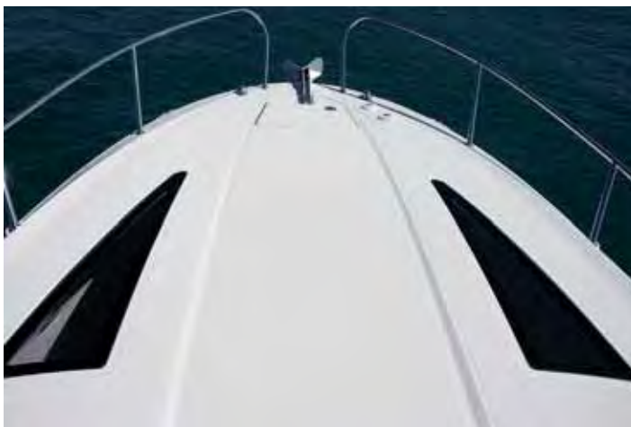
Dos superficies acristaladas en cubierta aseguran la luminosidad interior.
