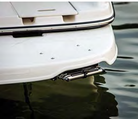
La estiba inferior de la escalera.
