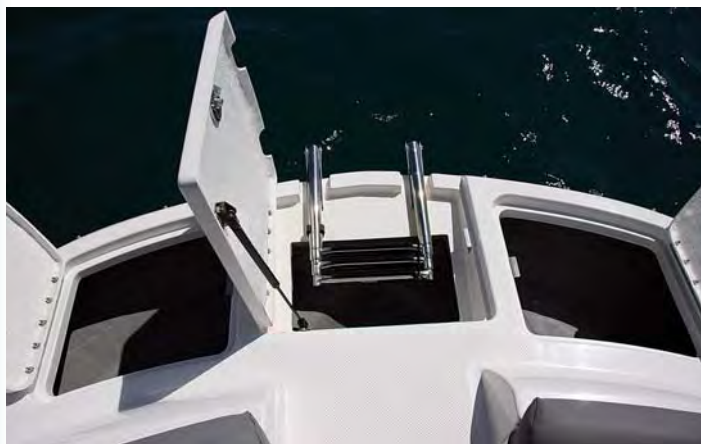
La plataforma de proa acoge un cofre de fondeo y dos estiba.
