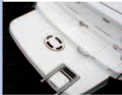
La escalera integrada en el molde.
