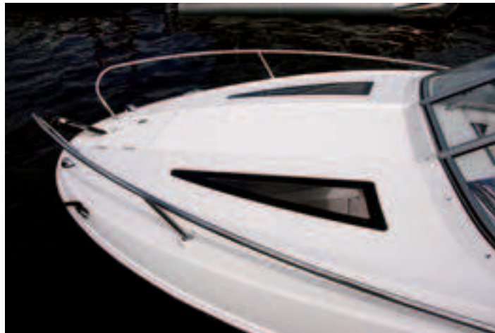
Las secciones fijas transparentes de cubierta proporcionan buena luminosidad interior.
