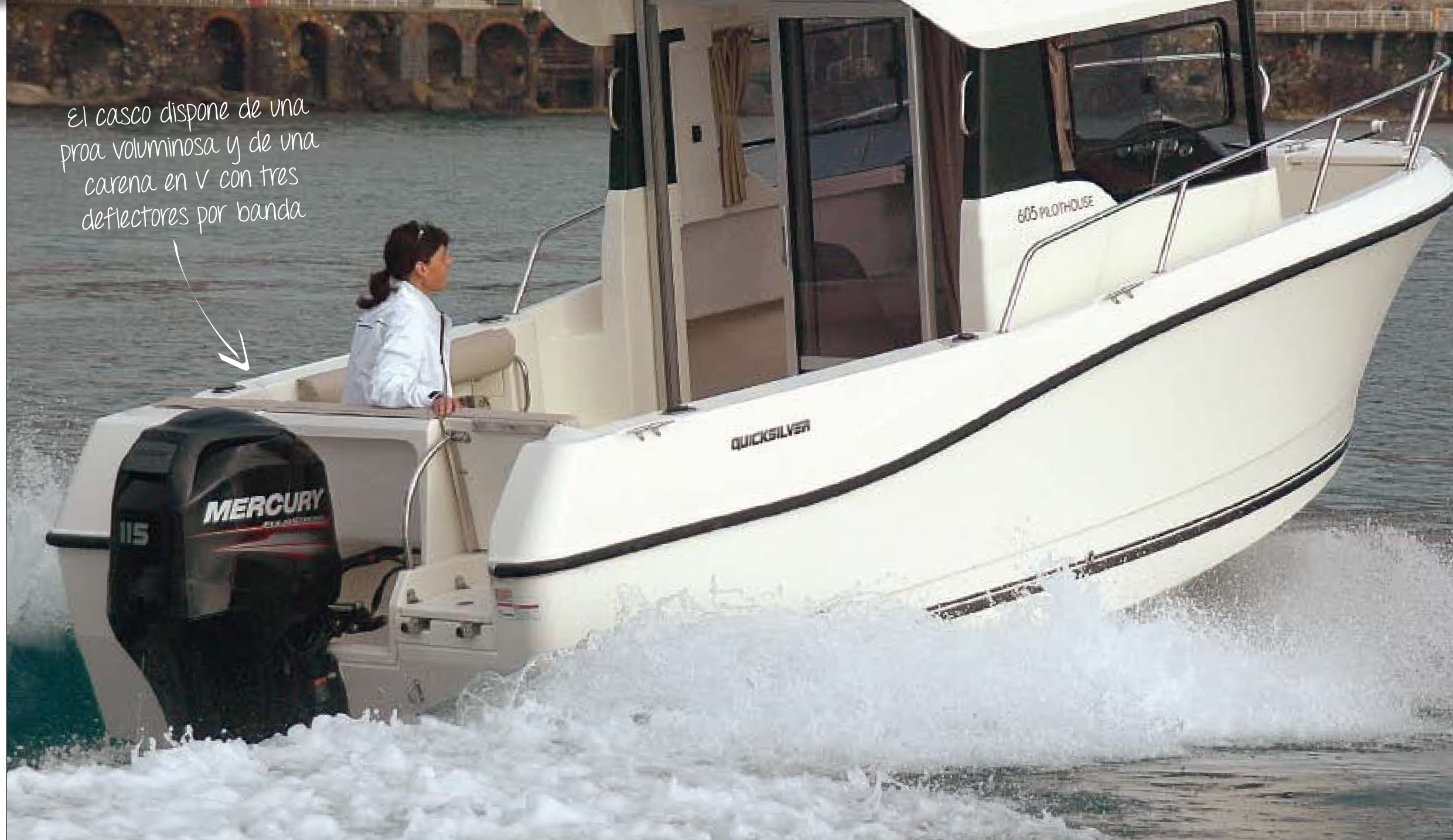
La disposición asimétrica de la timonera reserva un pasillo de ancho seguro y confortable a estribor, protegido por un ligero francobordo y el candelero.
