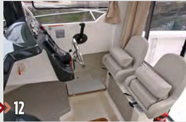
Con el fin de aprovechar el espacio, en la 605 se han unido los dos asientos monoplaza sobre un módulo de fibra.
