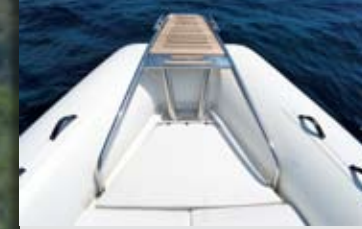
Totalmente a proa se ha optado por una interesante solución de delfinera de embarque directamente sobre la fibra, en lugar de sobre el flotador.
