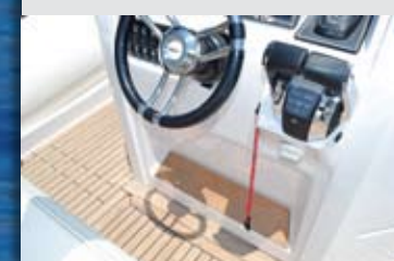
Un peralte de fibra forrado en teca nos permite asegurar mejor la posición en conducción alzada.
