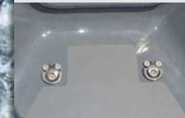
Varios cáncamos Wichard nos permitirán izar fácilmente y sin problemas la embarcación para sacarla del agua o botarla.
