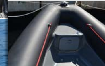
Bajo la cornamusa con mordaza encontramos un pequeño registro también útil como escalón entre cubierta y flotador en proa.
