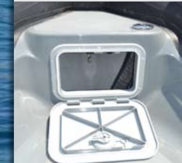
El registro de proa tiene una limitada capacidad de estiba y deja a la vista el tubo para el llenado de combustible.
