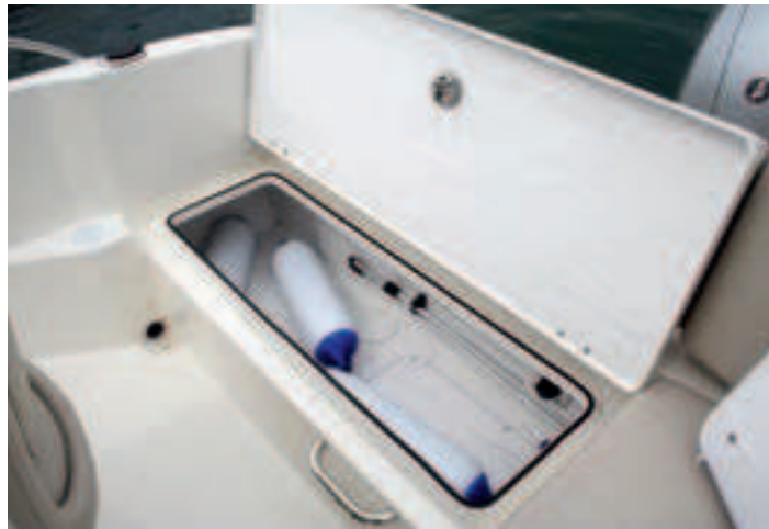
El mástil de la luz de alcance se estiba en el cofre de popa.
