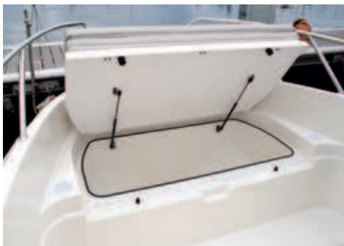
El cofre de proa cuenta con una tapa doble desplegable para formar el solárium.
