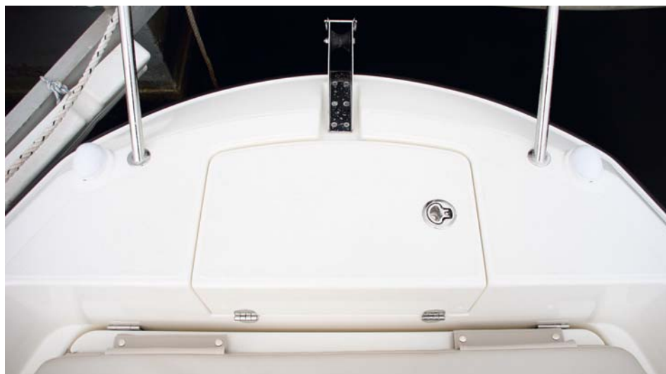
La tapa del cofre de fondeo de la Open acoge parte del perfil estructural.
