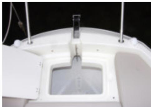
Cofre de anclas de la Sun Deck se encuentra debajo de las colchonetas del solario. Éste es profundo y admitiría un molinete de poca potencia.
